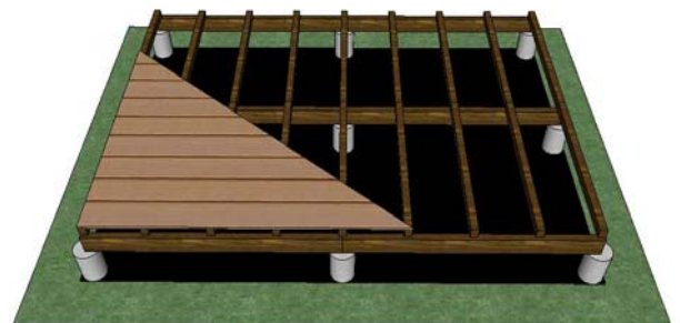
Pose des lames de terrasse à joints perdus
