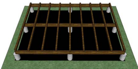
Pose des chevrons cl 4 (80mmX60mm longueur 3m) (Entraxe 50 cm)
